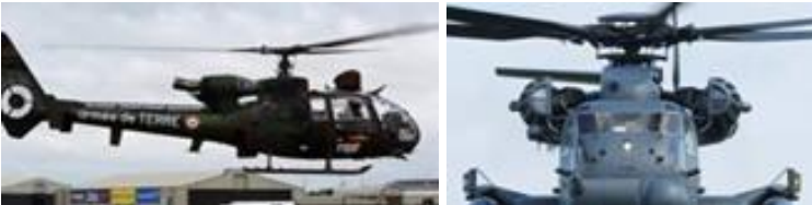
Figuur 9-56 (links): motor open achter hoofddrotor; figuur 9-57 (rechts): motor tegen zijkant romp
