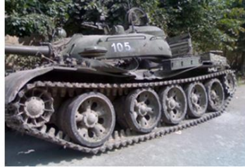
Figuur 9-37: Christie-loopwerk; rupsband (track) loopt direct over de bovenzijde van de loopwielen
