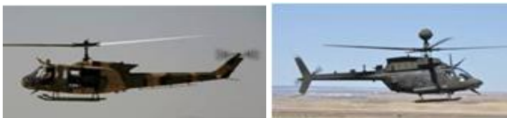
Figuur 9-71 (links): staartboom met knik; figuur 9-72 (rechts): staartboom met knik zowel omhoog als omlaag gericht
