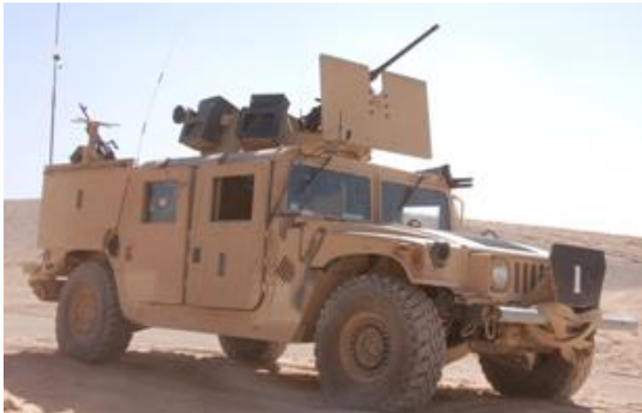
Figuur 9-28: HMMW 2 assen, 4x4 wielen (rechterzijde)
