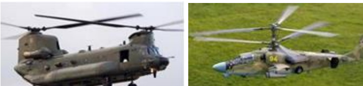
Figuur 9-63 (links): twee hoofdrotors achter elkaar; figuur 9-64 (rechts): twee hoofdrotors boven elkaar
