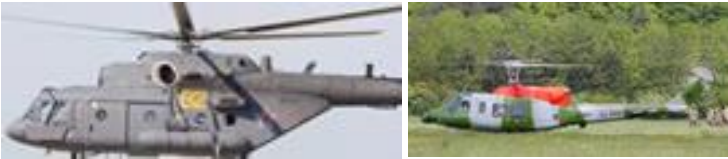
Figuur 9-54 (links): motor ingebouwd voor hoofddrotor; figuur 9-55 (rechts): motor ingebouwd onder hoofddrotor
