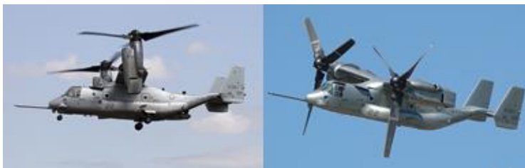
Figuur 9-65: twee hoofdrotors naast elkaar die gekanteld kunnen worden zodat ze dienst doen als propellermotoren (contraroterend)
