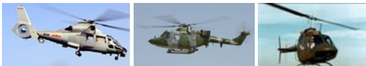
Figuur 9-66 (links): ingebouwde staartrotor; figuur 9-67 (midden): rotor dicht op romp; figuur 9-68 (rechts): rotor hoog boven romp
