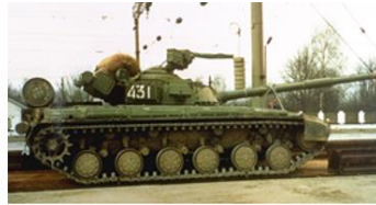
Figuur 9-38: verbeterd Christie-loopwerk; rupsband (track) wordt aan de bovenzijde geleid over toprollers
