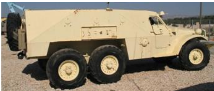
Figuur 9-29: BTR-152 3 assen, 6x6 wielen (rechterzijde)
