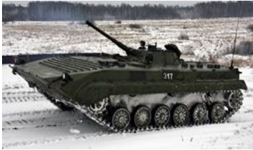
Figuur 9-45 (links): BMP-1 kort dik 73mm-kanon; figuur 9-46 (rechts): BMP-2 lang dun 30mm-kanon
