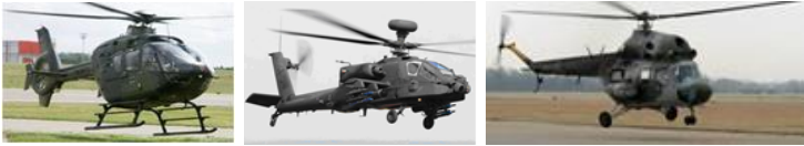
Figuur 9-58 (links): buizenframe; figuur 9-59 (midden): wielen (2 voor, 1 achter); figuur 9-60 (rechts): wielen (1 voor, 2 achter)
