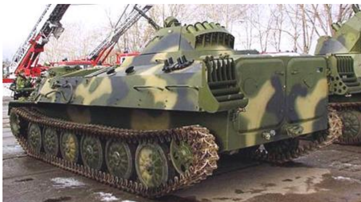
Figuur 9-42: MT-LB6MA gladde, rechte achterzijde
