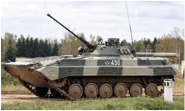
Figuur 9-45 (links): BMP-1 kort dik 73mm-kanon; figuur 9-46 (rechts): BMP-2 lang dun 30mm-kanon
