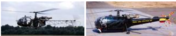
Figuur 9-69 (links): open staartboom zonder knik; figuur 9-70 (rechts): staartboom zonder knik
