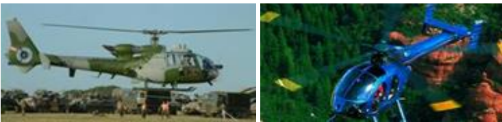
Figuur 9-61 (links): hoofdrotor met staartrotor in staartboom; figuur 9-62 (rechts): hoofdrotor met uitstroomopeningen
