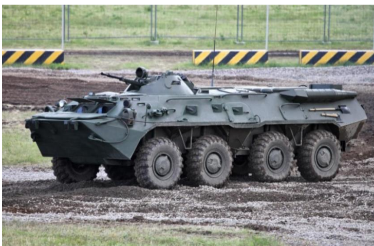
Figuur 9-30: BTR-80 4 assen, 8x8 wielen (linkerzijde)
