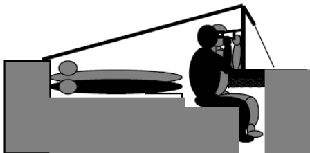
Figuur 4-3: zijaanzicht waarnemings- en luisterpost voor vier personen
