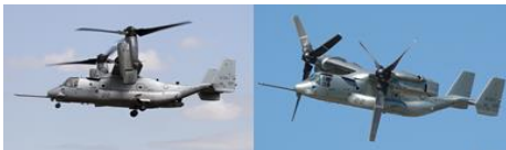
Figuur 5-28 (links): twee hoofdrotors naast elkaar die (zie figuur 5-29, rechts): tevens gekanteld kunnen worden om dienst te doen als propellermotor (contraroterend)
