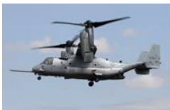
Figuur 165-3 Twee hoofdrotors naast elkaar die tevens gekanteld kunnen worden om vervolgens dienst te doen als propeller motor (contra roterend).
