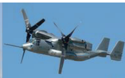
Figuur 165-3 Twee hoofdrotors naast elkaar die tevens gekanteld kunnen worden om vervolgens dienst te doen als propeller motor (contra roterend).
